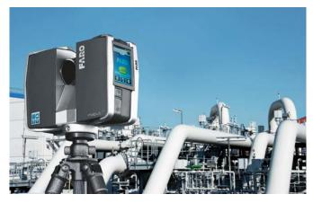
flektierten Lichts" wird daraufhin mit der der bekannten Frequenz verglichen. Der Unterschied zwischen den beiden Wellenspitzen ist die sogenannte "Phasenverschiebung". Scanner, die mit Phasenverschiebung arbeiten, gehören zu den genauesten und schnellsten Scannern auf dem Markt.
