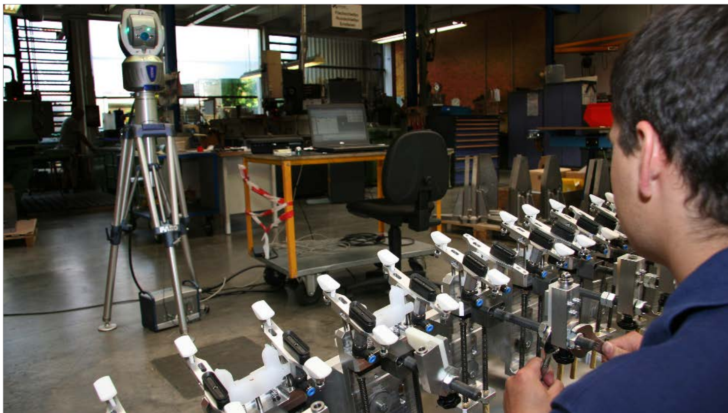
Der Laser Tracker verfolgt und misst die Position des Reflektors und liefert umgehend Messergebnisse.
