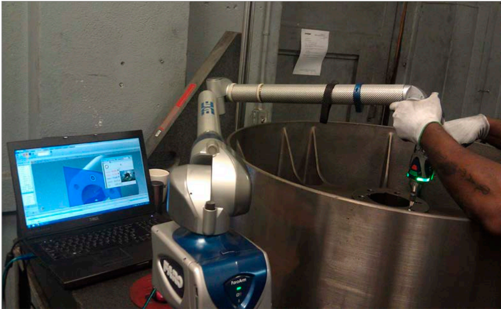
La maniabilité du FARO Edge permet à l'opérateur d'atteindre tous les éléments requis de la pièce à mesurer.
