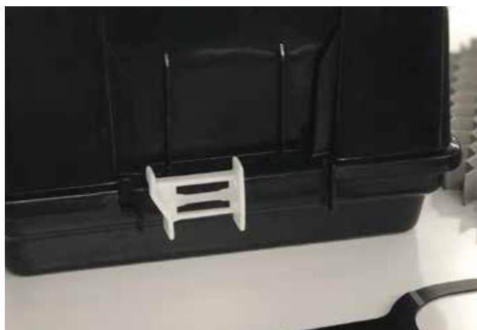
已停产的零件可以通过逆向工程过程 - 扫描、建模和三维打印轻松替换。
