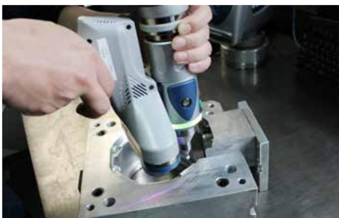
在扫描反光材料时，Edge ScanArm HD采用的蓝光技术确保了极佳的扫描结果。
