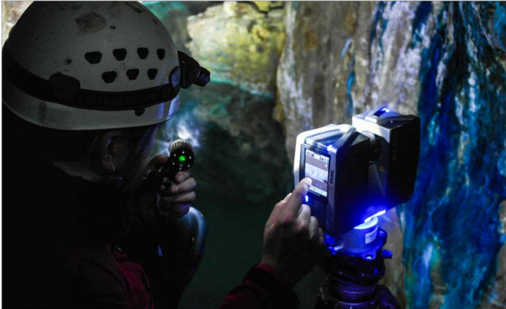
Numérisation des galeries souterraines avec le Focus 3D de FARO
