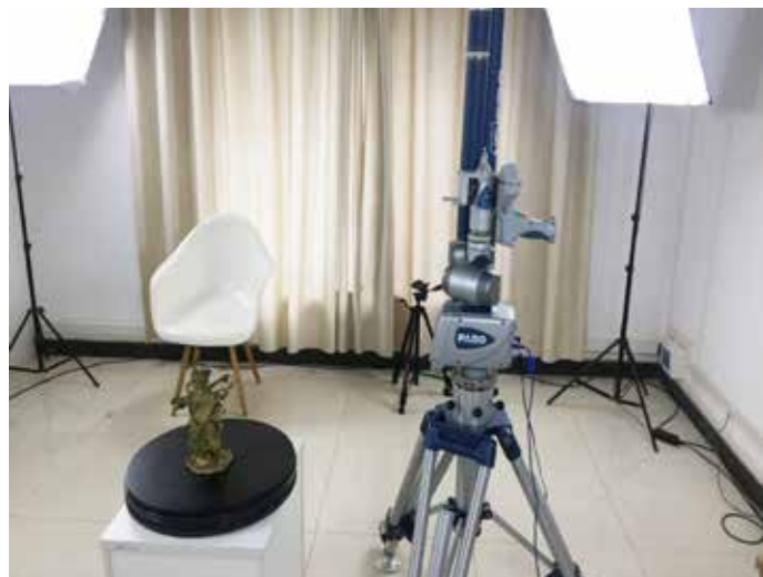
FARO Design ScanArmを使用し、ブロンズ像をデジタル化。
