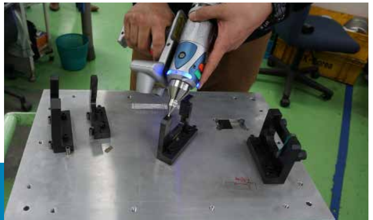
接触プローブで検査治具のキャリブレーションを行う。
