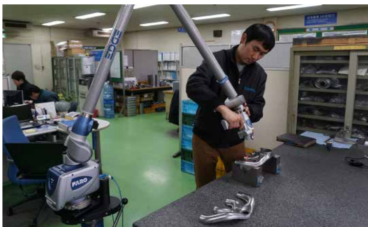
FARO Edge ScanArmは人間の腕の形をしたポータブル3次元測定器。
