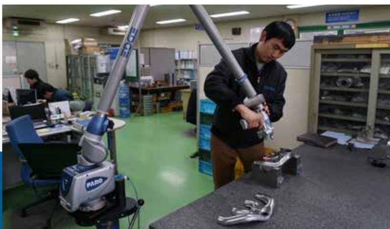
ScanArm ES 是一款便携式 3D 测量设备，外形就像人的手臂，依托于关节设计，测量臂可以自由移动，测量可以通过测探或者3D激光扫描目标物体两种方式实现。只需几秒，ScanArm ES 就能获得含有数百万个点的点云数据。
