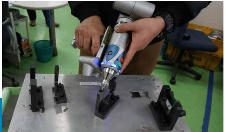
用接触式测头校准检具。
