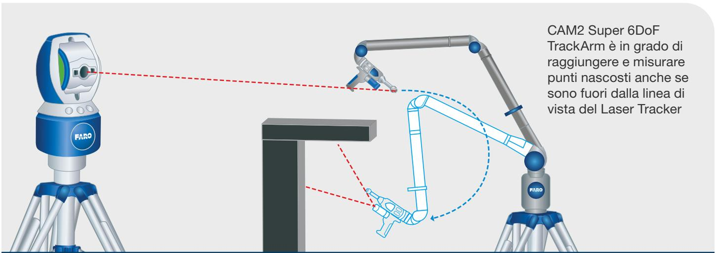
CAM2 Super 6DoF TrackArm è in grado di raggiungere e misurare punti nascosti anche se sono fuori dalla linea di vista del Laser Tracker
