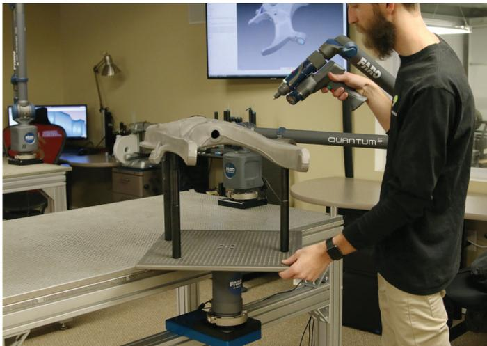
Figura 3. Amos Denbesten, métrólogo de Diverse Dimensions, escaneando con el 8-Axis QuantumS ScanArm
