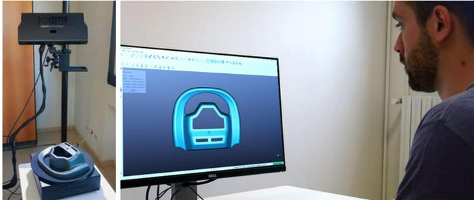
Un escáner 3D de luz estructurada proyecta luz blanca con patrones sobre un objeto. (Imágenes cortesía de Open Technologies).
