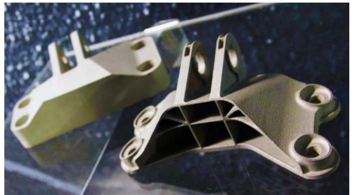
En el fondo, un soporte aeroespacial de metal producido con procedimientos tradicionales de diseño y fabricación. En primer plano, una pieza impresa en 3D con topología optimizada.
