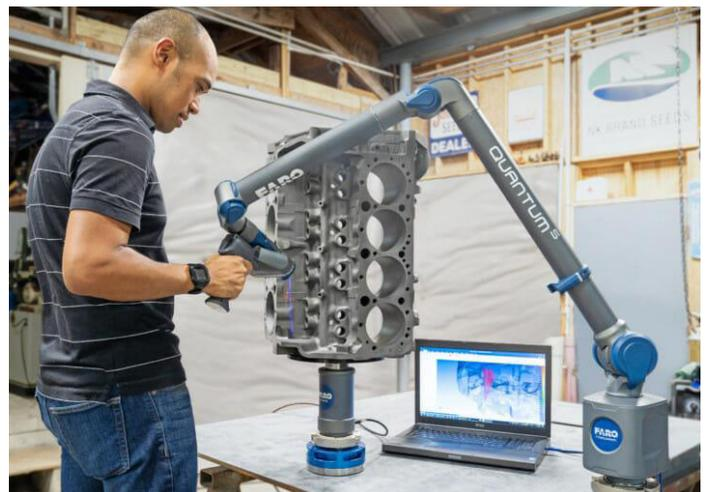
Se utiliza un escáner láser para capturar datos de un bloque de motor, con la ayuda de una plataforma giratoria. (Imagen cortesía de FARO Technologies).
