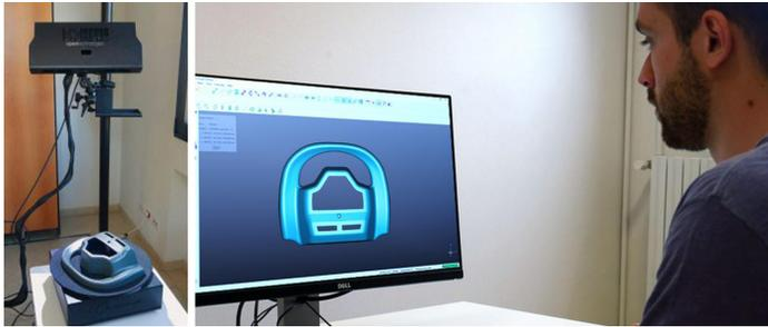
Um scanner 3D de luz estruturada projeta uma luz branca padronizada em um objeto. (Imagens fornecidas pela Open Technologies.)
