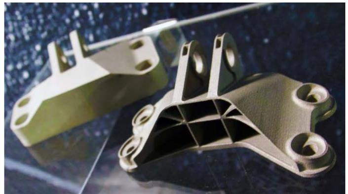
Ao fundo, um suporte aeroespacial de metal produzido com design e processo de fabricação tradicionais. No primeiro plano, uma peça impressa em 3D com topografia otimizada.
