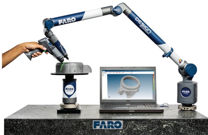
O FARO® 8-Axis Design ScanArm 2.5C inclui uma plataforma rotativa que garante digitalizações mais rápidas e precisas. (Imagem fornecida pela FARO Technologies.)
