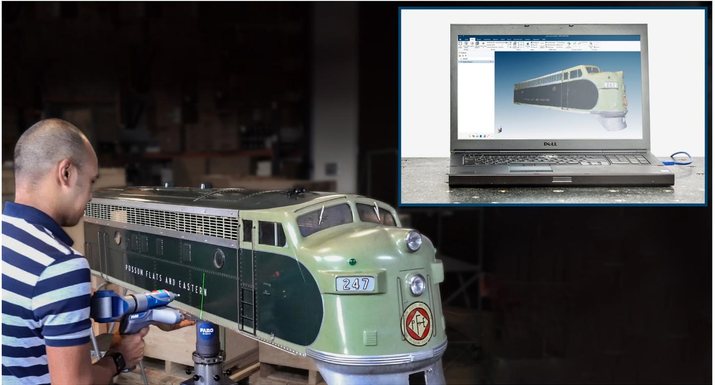
Un gran tren modelo se ubica en la parte superior de la plataforma giratoria para que el escaneo del objeto completo sea mucho más fácil para el usuario. (Imagen cortesía de FARO).
