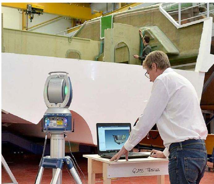
O FARO Laser Tracker foi configurado para inspecionar o posicionamento dos componentes no casco das embarcações.
