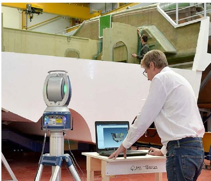
El FARO Laser Tracker está configurado para inspeccionar la posición exacta de los componentes en el casco del barco.
