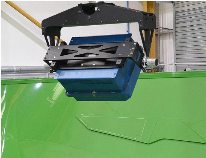
FARO Laser Projector proyecta plantillas para determinar posiciones en el casco.
