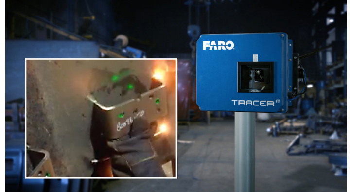
Figura 4. Implementación en taller de soldadura industrial. El Tracer ™ es suficientemente resistente para el área de producción, con una carcasa industrial hermética al polvo.
