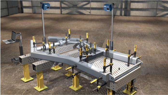
Figura 3. Dois projetores Tracer<sup>M</sup> em uma operação de montagem.
