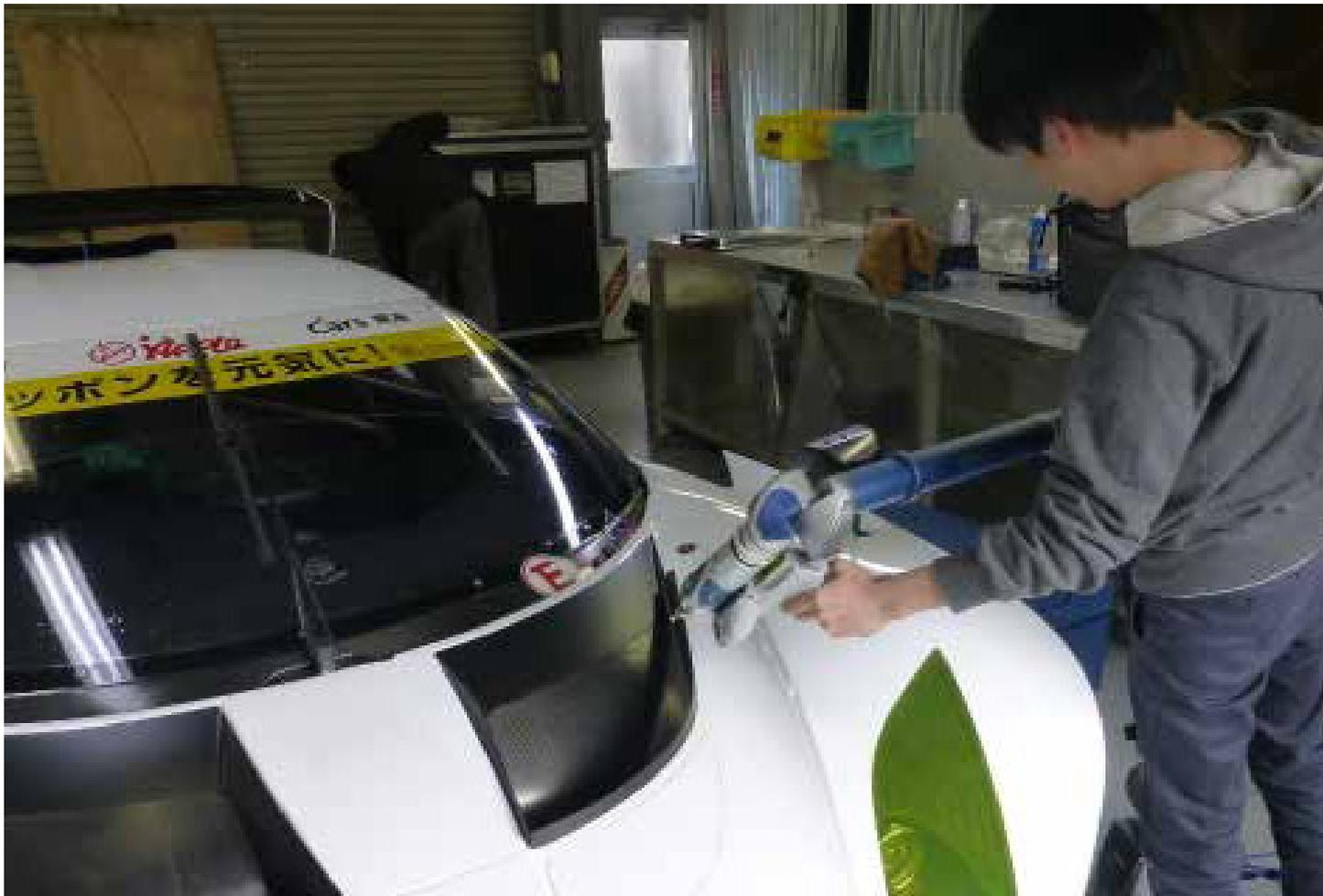
Um funcionário da Mooncraft demonstra como o FARO Design ScanArm é usado para digitalizar componentes de um carro de corrida.
