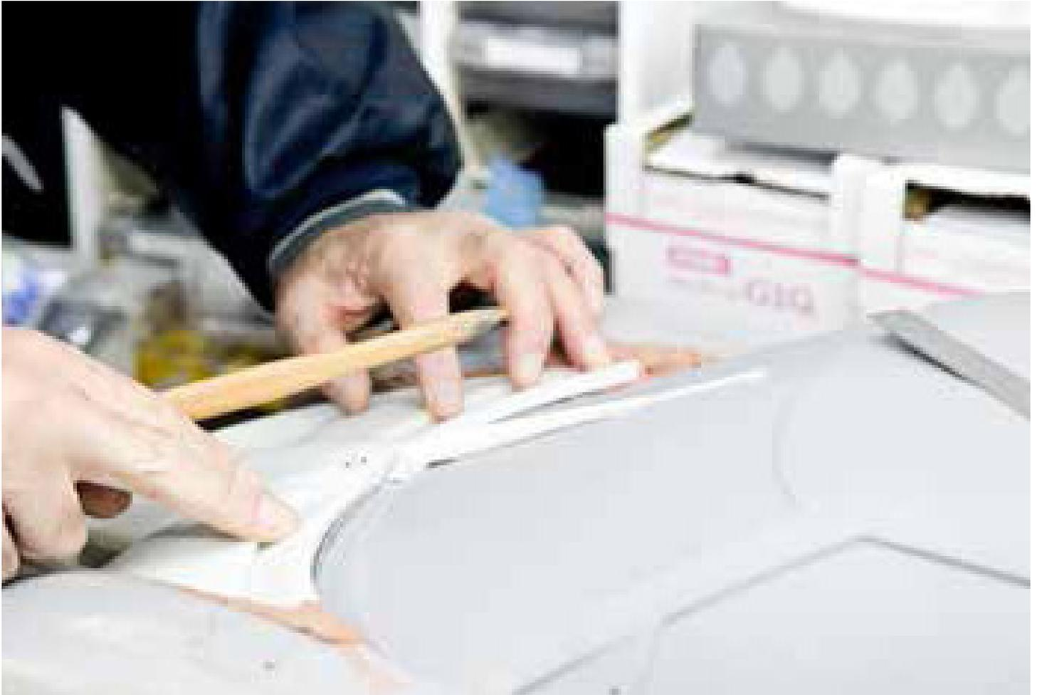
*Acoplamento de uma peça em 3D ao modelo 1:5, que passará pelo teste do túnel. O processo ajuda a Mooncraft a criar um carro mais rápido e seguro.*
