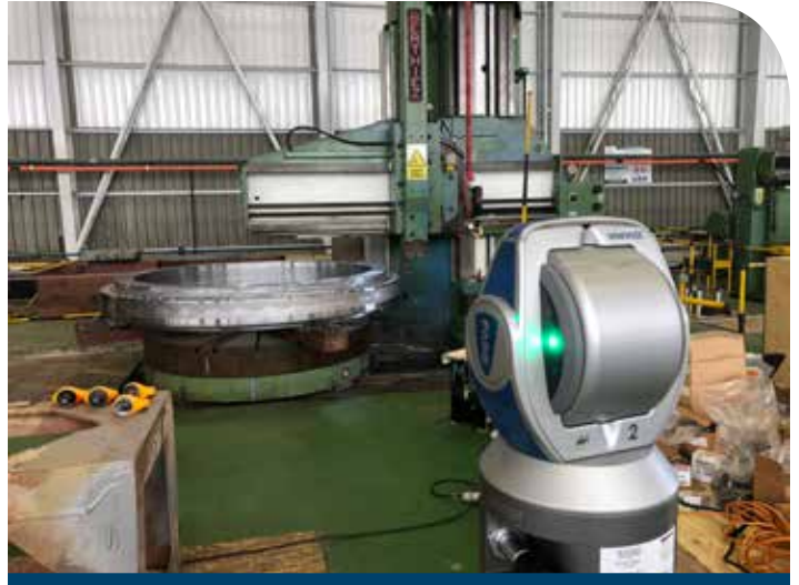
Figura 3. Vantage Laser Tracker tomando mediciones en la carcasa de un rodamiento
