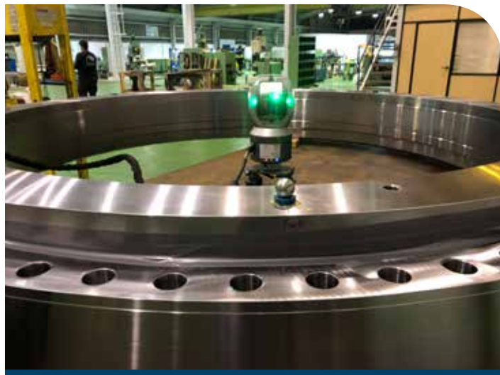
Figura 2. Vantage Laser Tracker tomando mediciones en la máquina durante el proceso de maquinado para la carcasa de un rodamiento
