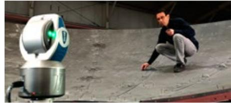
Los blancos retro-reflectantes varían, pero el más popular es el retro reflector esférico montado (SMR). Cuando la luz vuelve a entrar en el Tracker, dos codificadores angulares miden los ángulos de elevación y rotación, mientras que una medidora de distancia absoluta de alta precisión es utilizada para determinar la posición 3D del objetivo.
