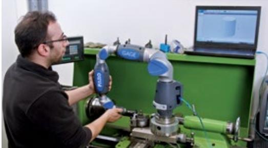
Un brazo articulado es una MMC portátil que determina y registra la ubicación de una sonda en el espacio 3D e informa los resultados a través de software. Con el fin de calcular la posición de la punta de la sonda, el ángulo de rotación de cada articulación y la longitud de cada segmento en el brazo debe ser conocida. Alcance radial cuando se extiende normalmente oscila entre 2 metros (6 pies 4 pies a 12 pies de diámetro o volumen de trabajo).
