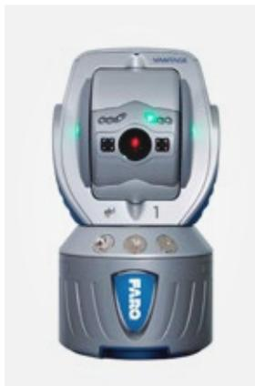
Muchas aplicaciones industriales requieren mediciones muy precisas a gran escala. El Laser Tracker es una máquina de medición de coordenadas (MMC) portátil que permite a los usuarios alcanzar sus objetivos, fácilmente con precisión rápida y reemplaza las herramientas como cuerda de piano, plomadas, máquinas de diseño, teodolitos, tránsito óptica y estaciones totales.
