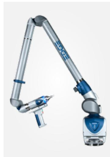
La implementación de una solución de metrología portátil precisa y accesible, tal como un brazo articulado directamente en la línea de producción, puede eliminar los retrasos y dar lugar a una mayor eficiencia. Resultados de las mediciones no varían entre los operadores, y usted tiene la capacidad de comparar con los datos CAD.
