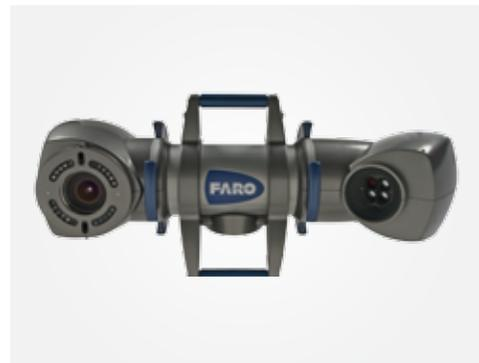
Los 3D Imagers utilizan técnicas de luz estructurada, los cuales pueden ser un patrón único de líneas o puntos. Estas proyecciones son vistas por una o más cámaras, y a través de una serie de cambios en las proyecciones, las coordenadas 3D se pueden determinar para cada píxel de la cámara. Por ejemplo, un 3D Imager con una cámara de 4 mega píxeles producirá 4 millones de puntos por medida.
