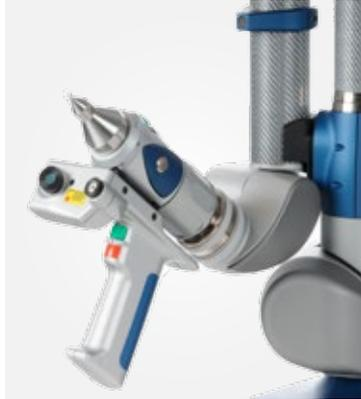
En muchos casos, el producto o pieza para inspeccionar está hecho de materiales suaves y deformables, por lo que la medición precisa de contacto se hace muy difícil. Sin embargo, el uso de la tecnología láser permite una alta precisión sin necesidad de contacto directo.
