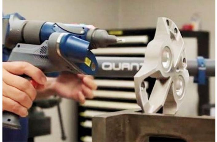
Ejecución de la inspección con un FARO Quantum<sup>S</sup> ScanArm
