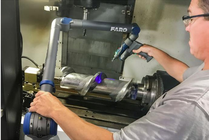
Inspección en la máquina
