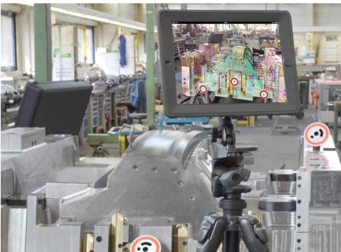
El software FARO® Visual Inspect™ AR permite la visualización intuitiva de datos 3D complejos para realizar verificaciones virtuales de calidad en piezas y ensamblajes, incluso en las primeras etapas del proceso de ensamblado. Los usuarios pueden, por ejemplo, verificar si todos los orificios perforados están en su lugar y si los componentes (que podrían no estar físicamente presentes) encajarán en el ensamblaje actual.
