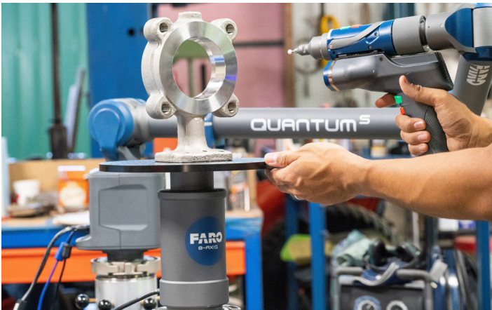
El sistema FARO 8-Axis proporciona una innovadora funcionalidad de rotación de piezas en tiempo real que mejora los procesos de inspección de calidad
