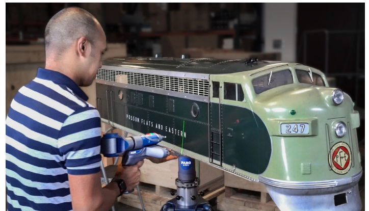
Escanear grandes objetos a color es una tarea rápida y sencilla gracias al 8-Axis ScanArm y al palpador de línea láser a color PRIZM
