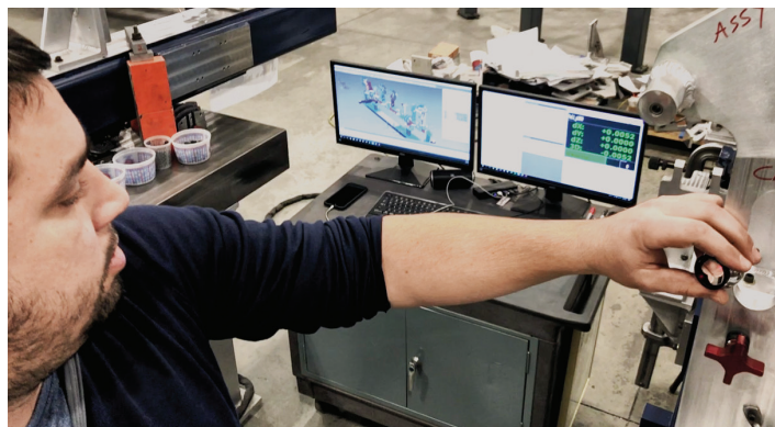
Chad Fortune de Datum Metrology usando el software BuildIT y un Vantage E Laser Tracker para medir instalaciones de grúas y herramientas en el sitio del cliente.
