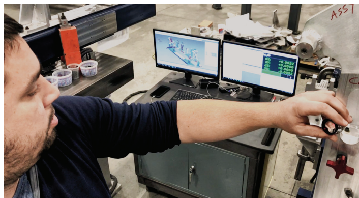
Chad Fortune, da Datum Metrology, usando o software BuildIT e um Laser Tracker Vantage E para medir ferramentas de reparo e gabarito nas instalações de um cliente.
