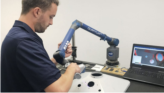
Inspección de una cubierta de un dispositivo de diagnóstico médico, utilizando un FARO Quantum M ScanArm y CAM2
