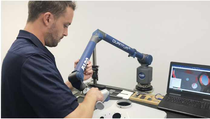
O FARO Quantum M ScanArm e CAM2 inspecionando a capa de um dispositivo diagnóstico médico
