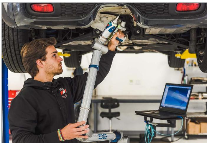
O FARO Edge ScanArm é a ferramenta ideal para inspeção, comparação da nuvem de pontos com o CAD, prototipagem rápida, engenharia reversa e modelagem em 3D, e se tornou indispensável nos processos da AWE Tuning.
