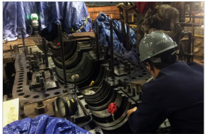
"Com o FARO Laser Tracker, conseguimos medir a junta horizontal e todos os componentes internos simultaneamente com uma ferramenta, com resultados em 3D: horizontal, vertical e axial. Com os dados coletados, obtemos os dados de ovalização", complementa Josefsberg. Com a redução no número de ferramentas, ocorre um aumento natural da usabilidade e da precisão.
