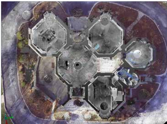
Figura 3. Visão superior de todas as 19 posições de digitalização da parte externa do Fonthill Castle.
