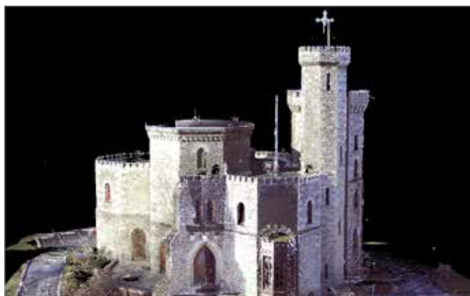
Figura 2. Projeto completo de digitalização da parte externa com o software SCENE.
