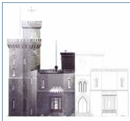
Figura 5. Ortoimagem da nuvem de pontos recortada, alinhada à elevação da parte externa em CAD.
