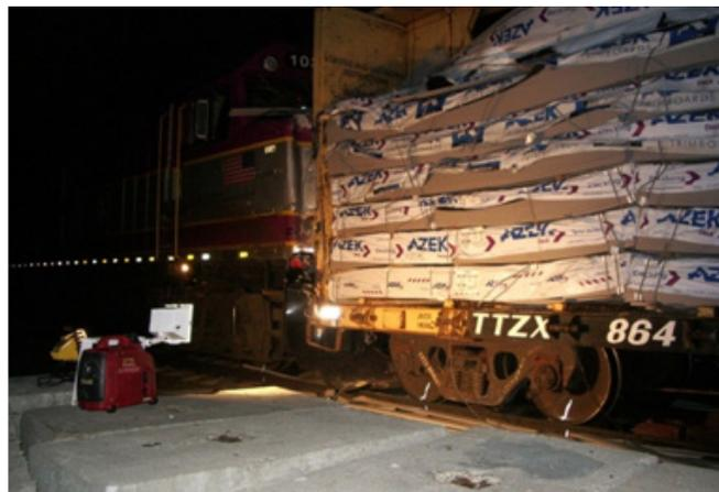
Después del accidente, los investigadores examinaron el descarrilador y lo encontraron en posición desactivado (OFF). Sin embargo, cuando se examinaron las ruedas del vagón de carga, se encontró pintura del descarrilador en las dos ruedas delanteras del vagón, pero no había pintura en las dos ruedas traseras.
