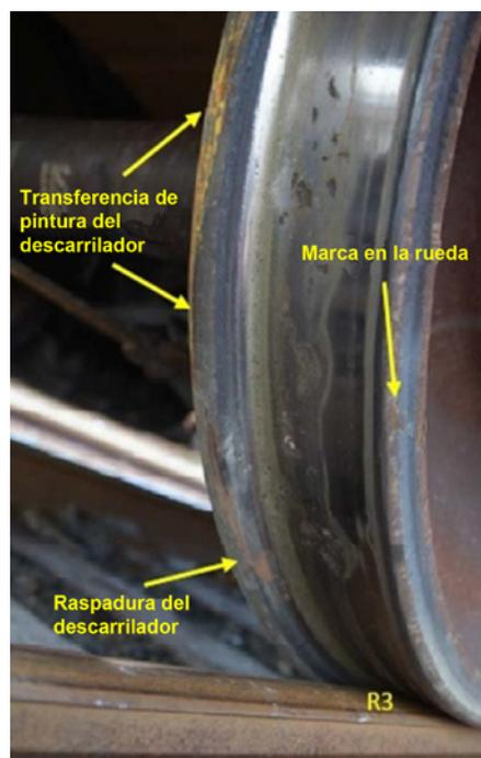
El componente principal de un descarrilador se llama zapata; es una pieza de metal fundido de 24 pulgadas de largo ubicada en la parte superior del riel y diseñada para evitar movimientos no autorizados o evitar que vehículos rodantes sin supervisión lleguen hasta una vía principal.
