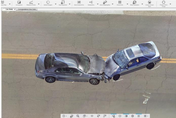
O laser scanner coleta marcas de tinta e de derrapagem, ranhuras e outras evidências físicas para determinar a posição dos veículos na cena com precisão.
