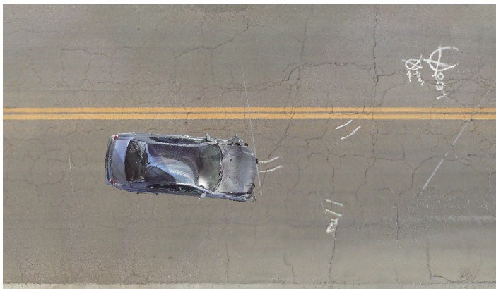
El Chrysler ® se escaneó en el desarmadero y el modelo 3D obtenido se ubicó digitalmente en la escena en el lugar del impacto.
