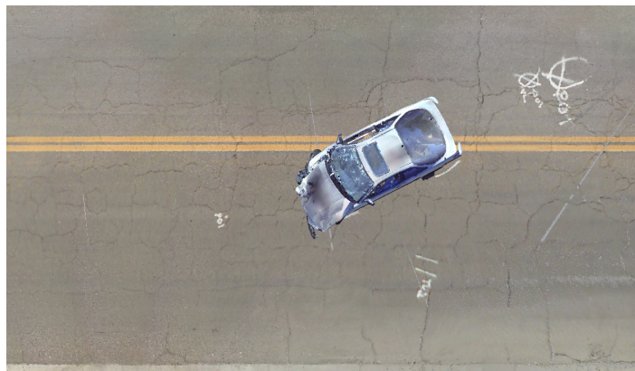
De forma similar, también se escaneó el otro vehículo en el choque, un Acura ® , después del evento y se ubicó digitalmente en la escena con el software.
