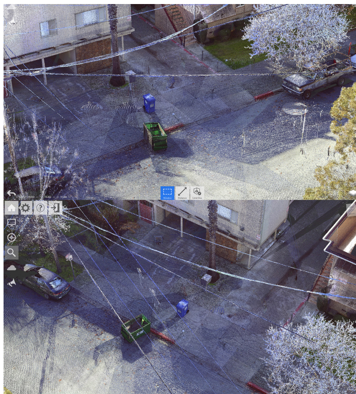
Toda la escena se escaneó usando un FARO Laser Scanner para crear una nube de puntos 3D con mediciones precisas. Los datos escaneados se usaron para crear una "cámara virtual" que coincidiera con la nube de puntos.
