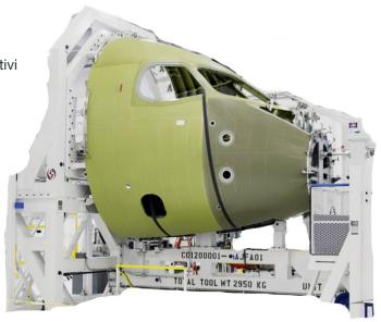
"Le nuvole di punti acquisite da Quantum<sup>E</sup> ScanArm e l'utilizzo del software CAM2 hanno permesso di generare modelli CAD estremamente precisi e di produrre in modo efficiente repliche esatte di ciascuno degli elementi scansionati. Nel primo progetto importante in cui sono stati utilizzati, Quantum<sup>E</sup> e il nostro nuovo software CAM2 hanno dimostrato le loro capacità avanzate e hanno consentito un notevole risparmio di tempo e il completamento di un lavoro di alta qualità."
