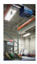
Ambos proyectores láser, cuando se emparejan con el software BuildIT Projector que tiene la nueva función ScanAlign, se pueden utilizar para automatizar la alineación con objetivos anteriores.
