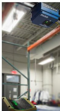
Ambos os projetores a laser, quando pareados com o BuildIT Projector Software, que possui o novo recurso ScanAlign, podem ser usados para automatizar o ajuste com alvos retrorreflexivos.
