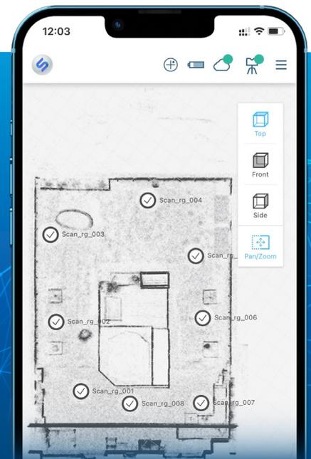
À l'origine, Sphere est un outil de gestion des données dans le cloud. Et avec le logiciel FARO WebShare servant de visionneuse web, les utilisateurs peuvent explorer et partager les données 3D capturées et comparer ces données avec la conception sous forme de données de CAO ou BIM. Les utilisateurs auront également accès aux plateformes d'assistance client de FARO : base de connaissances, assistance FARO, et FARO Academy.
